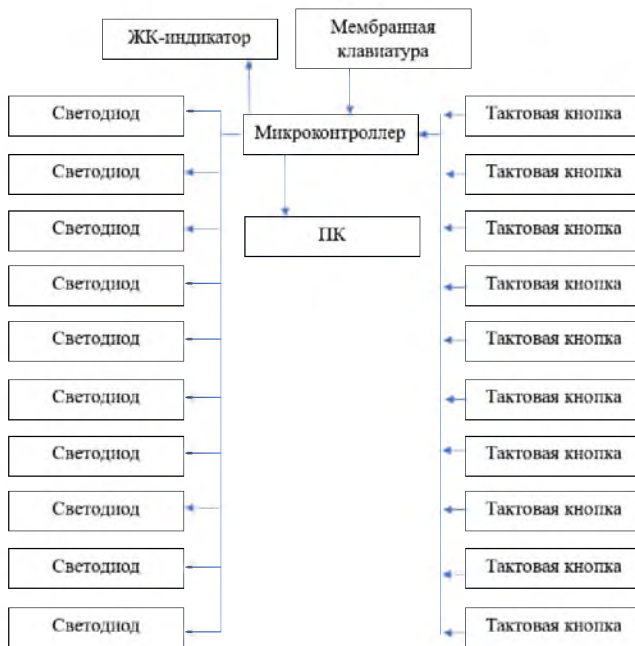
Рис. 3. Общая структура эмулятора пульта ШС-220
