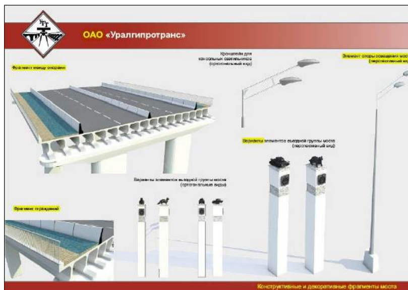
Рис. 1. Конструктивные и декоративные фрагменты моста
