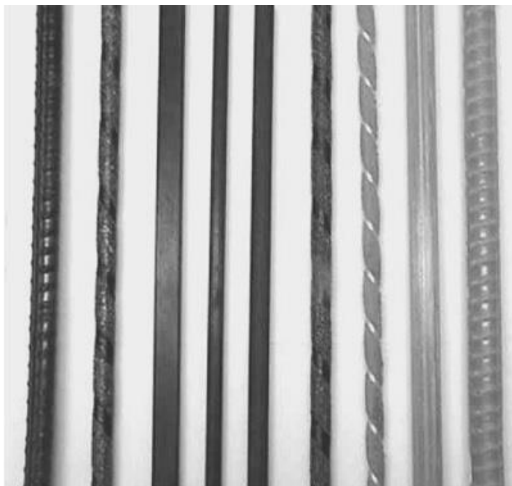
Рисунок 1.6. Типы стержней FRP, используемые в качестве арматуры (NSM)
