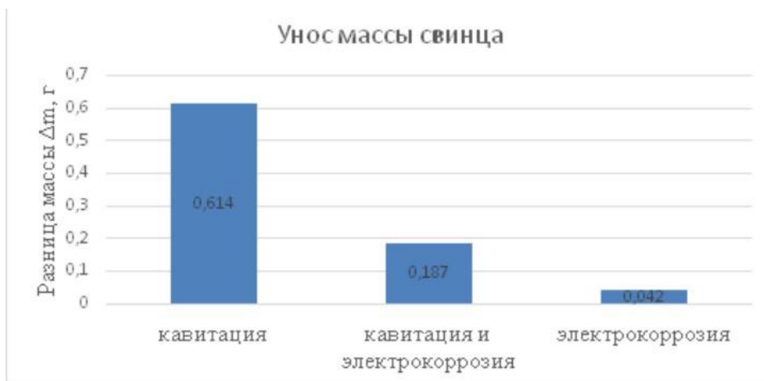
Рис. 1. Унос массы свинца при кавитационном, кавитационном и электрокоррозионном одновременно, электрокоррозионном разрушении соответственно.
