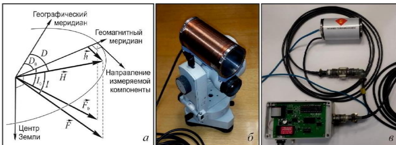
Рис. 1. Схема измерения (а) с помощью размещенной на немагнитном теодолите Т-30 системы высокооднородного поля (б), совмещенной с оверхаузеровским магнитометром POS (в)
