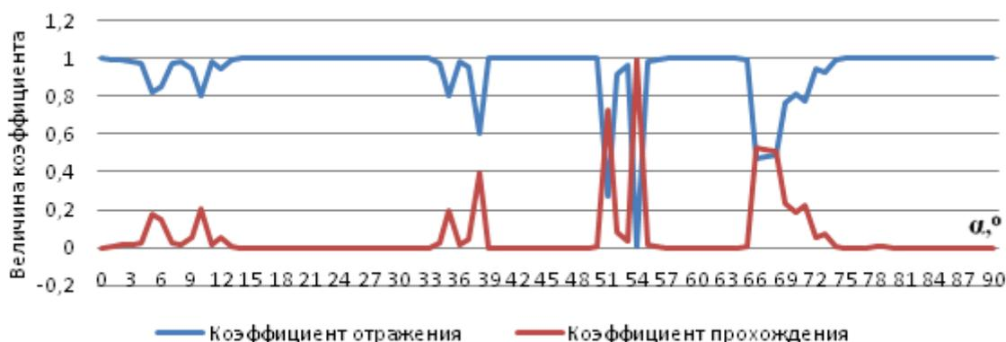
Рис. 1. Поведения коэффициентов отражения и прохождения при различных углах падения волны  $\alpha$ , при прохождении через слоистую периодическую структуру (LiF/Si/Ag<sub>2</sub>O/C) с резонансным слоем.
