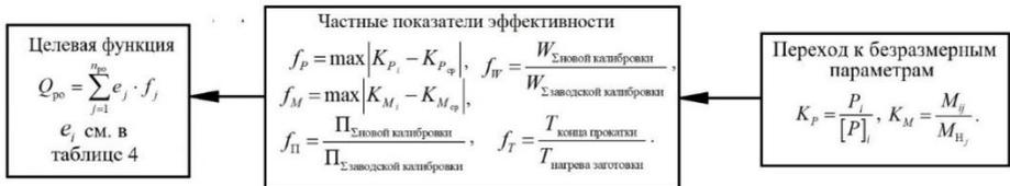
Рисунок 7 – Блок-схема расчета значения целевой функции критерия оптимальности режима обжатий
