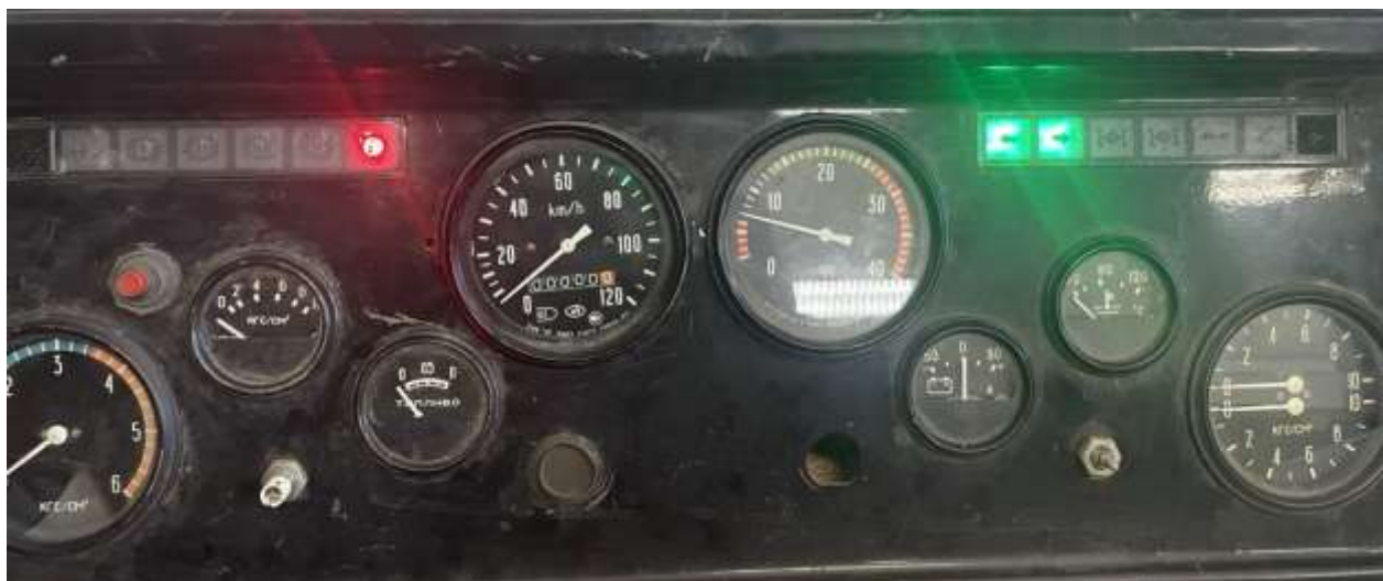
Рисунок 30 – оригинальная приборная панель, с включённой аварийной сигнализацией, фарами, запущенным двигателем и активированным стояночным тормозом.
