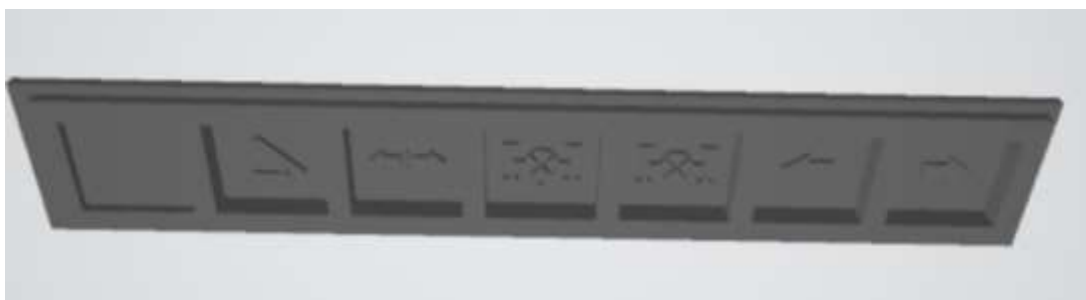
Рисунок 14 – Контрольные лампы с поворотниками, блокировками мостов, указателям поднятого кузова 3D модель.
