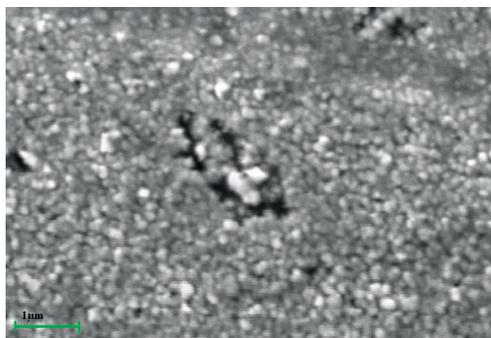
Рис. 1. Изображение поверхности стеклоглеродного электрода, модифицированного никельсодержащими наночастицами
