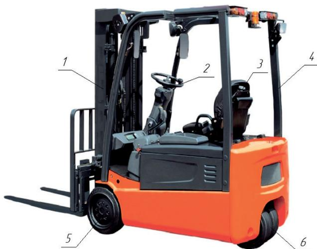
Рис. 1. Трехопорный вилочный погрузчик:
