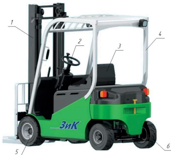
Рис. 2. Четырехопорный вилочный погрузчик:
