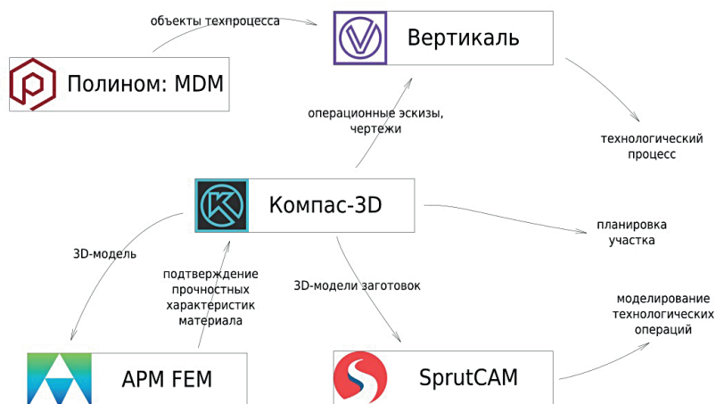
Рис. 1. Схема взаимодействия российских программ в единой конструкторско-технологической среде
