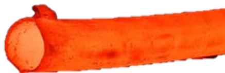
Рисунок 1 – Дефект прокатки: выпуски на задних концах трубы 219×8 – продольные «плавники» переменной высоты
