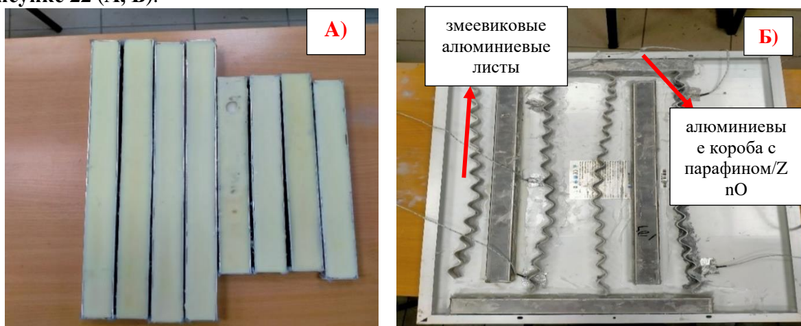
Рисунок 22- Элементы экспериментальной ФЭП: А) алюминиевые корпуса с парафином; Б) коробка парафина и змеевиковые алюминиевые листы, прикрепленные к тыльной стороне ФЭП
