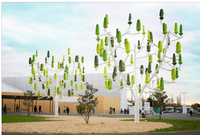
Рис. 1. Прототип компактной ветряной мельницы компании New Wind [9].
