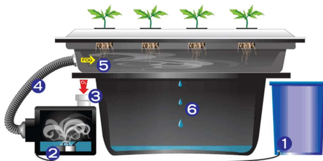
Рисунок 6 – Аэропоника с ультразвуковым генератором тумана
