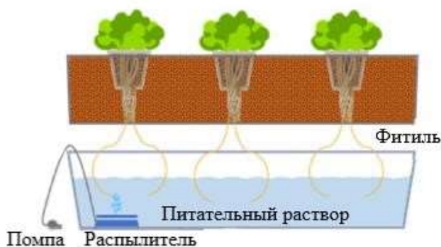
Рисунок 2 – Выращивание растений с помощью фитильной системы
