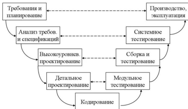
Рисунок 9 – Общий вид V-образной модели жизненного цикла информационной системы [54]
