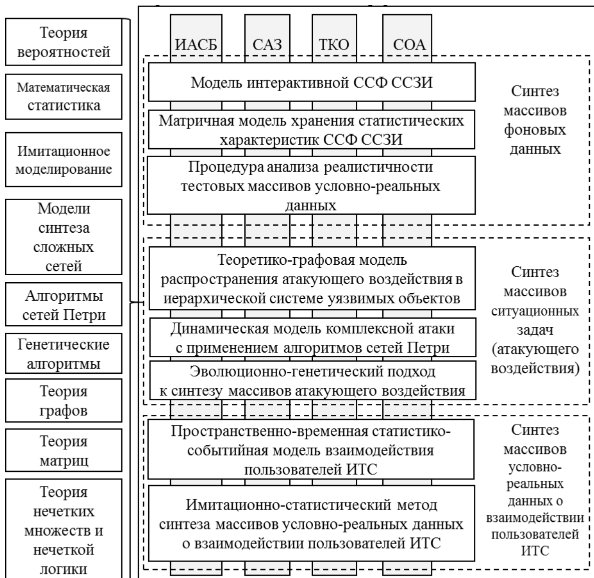
Рисунок 4. Схема компонентов комплексного метода синтеза интерактивной сетевой среды для компьютерных полигонов в сфере ИБ
