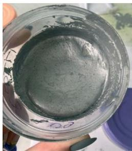
Рис. 2. Образец с фторопластом
