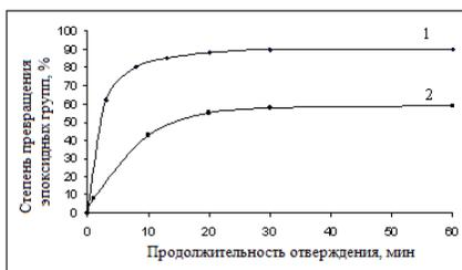
Рис. Зависимости степени превращения эпоксидных групп от продолжительности отверждения смолы ЭД-20 (100 масс.ч.): кривая 1 – 25%-ным раствором (I) в ТХЭФ (1 масс.ч.); кривая 2 – комплексом  $\text{BF}_3 \cdot \text{O}(\text{C}_2\text{H}_5)_2$  (1 масс.ч.).
