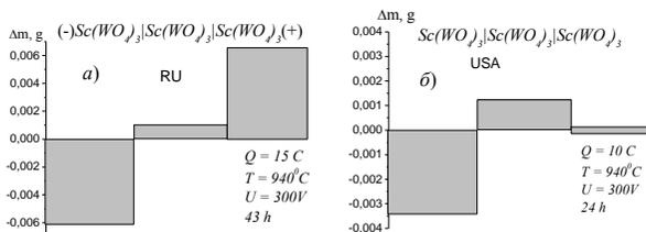
Рис 1 *а,б* Результаты опытов по Тубандту с брикетами полученными в разных лабораториях, (в поле рисунка обозначена страна, где была изготовлена керамика).
