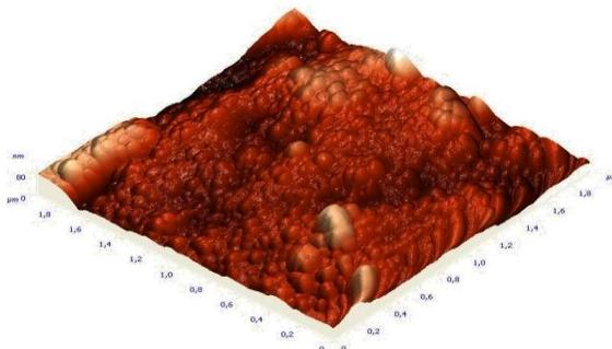
Рельеф поверхности образца висмута, на медной подложке, полученной на атомно-силовом микроскопе.
