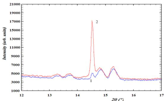
Дифрактограмма ПЭГ, выделенного из 90 % раствора: 1 – образец, закристаллизованный в отсутствие магнитного поля; 2 – образец, закристаллизованный в магнитном поле. Излучение  $\text{CuK}_\alpha$
