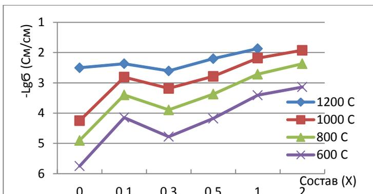
Рисунок 2 – Изотермические зависимости электропроводности твердых растворов от состава
