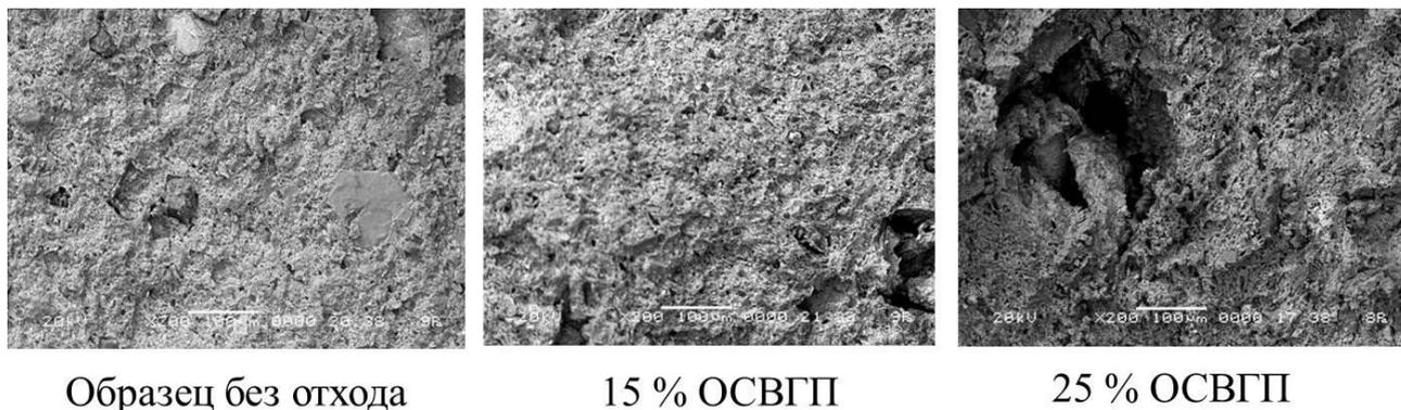
Рис. 1. Микроструктура образцов керамического кирпича
