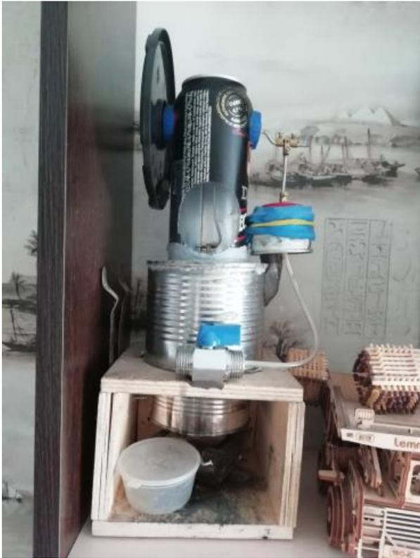
Рис.2. Экспериментальный бета-Стирлинг
