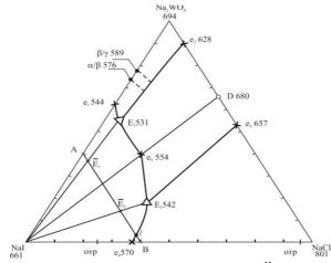
Треугольник составов трехкомпонентной системы NaCl–NaI–Na<sub>2</sub>WO<sub>4</sub> и расположение разреза AB
