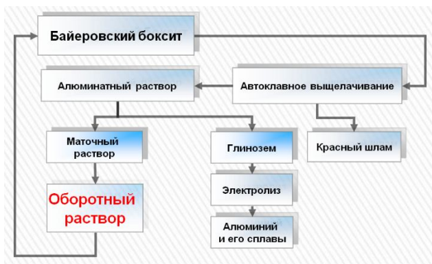
Рис. 1. Принципиальная схема переработки боксита методом Байера
