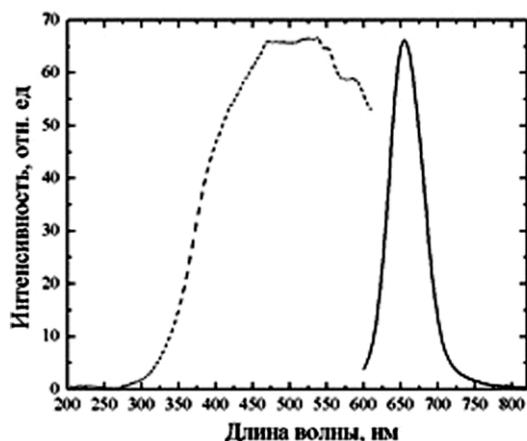
Рис. 1. Спектры поглощения и люминесценции квантовых точек CdTe/CdS
