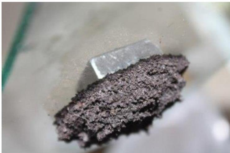
Рис. 1. Магнитоуправляемые нефтесорбенты, размер гранул 2-10 мм
