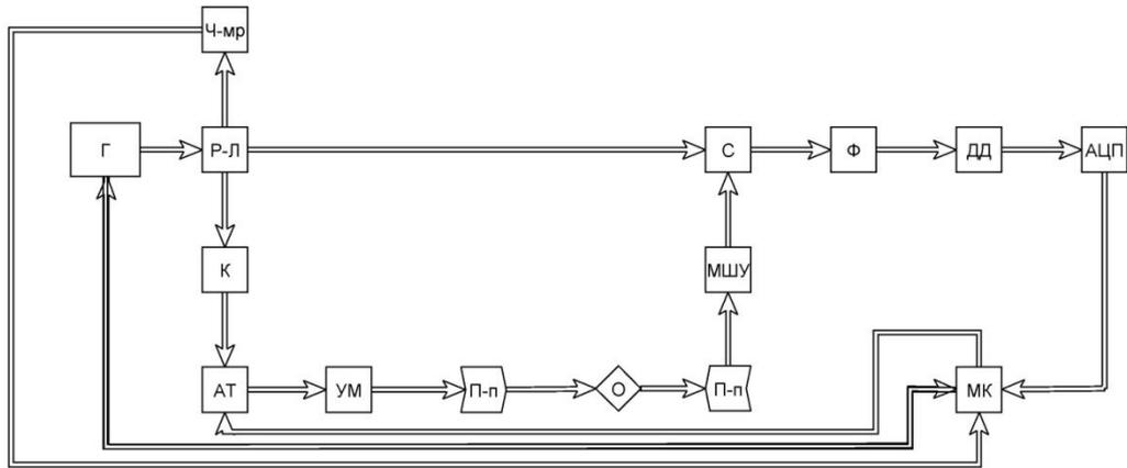
Рис. 1. Блок-схема ИС, где Ч-мр – частотомер; Г - генератор; Р-Л – радиочастотный разветвитель; К - ключ; АТ - аттенюатор; УМ – усилитель мощности; П-п пьезопреобразователь О; исследуемый образец; МШУ – малошумящий усилитель; С – смеситель сигналов; Ф – фильтр; ДД – дифференциальный драйвер АЦП; АЦП – аналогово цифровой преобразователь; МК – микроконтроллер.
