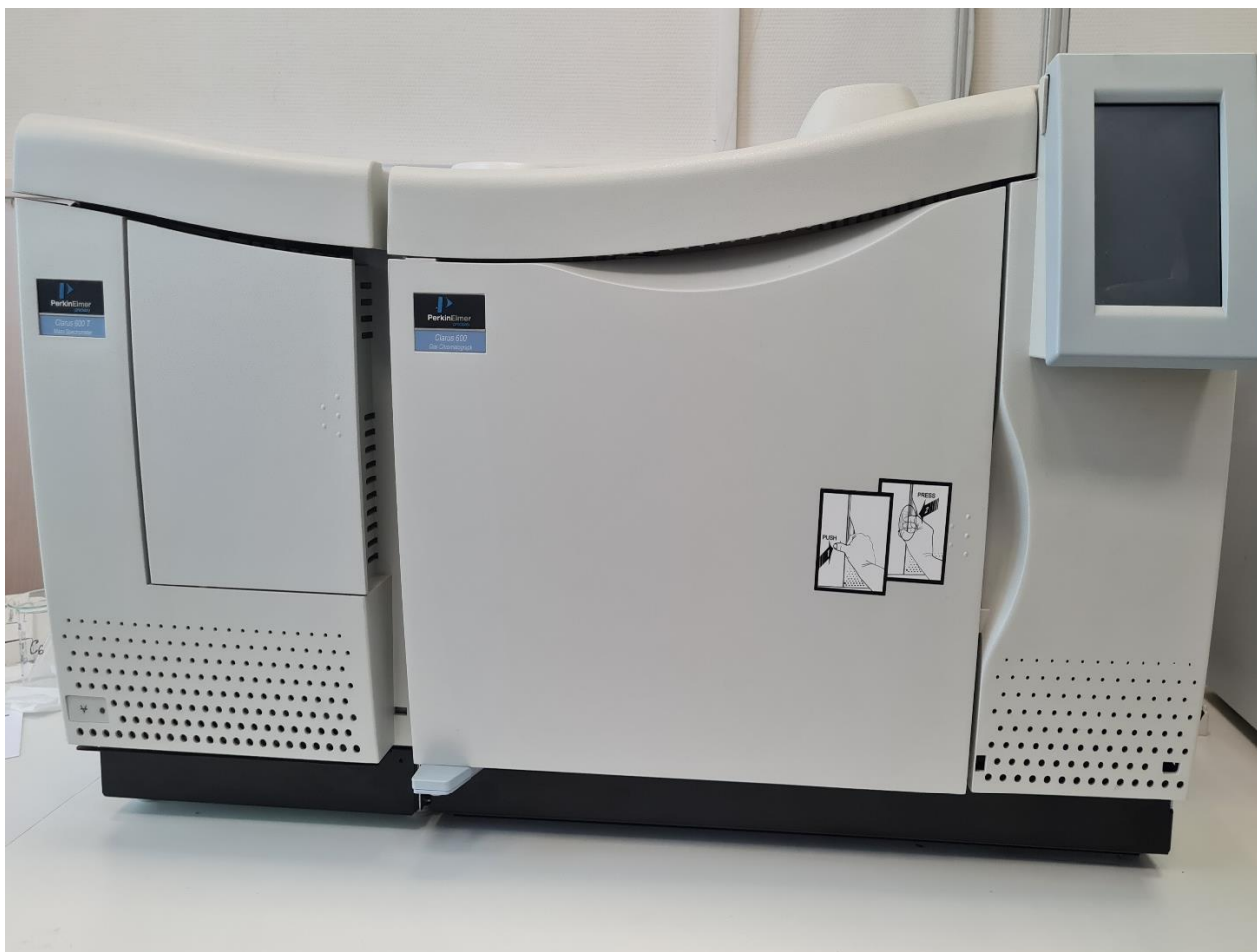
Рисунок 1 – Газовый хроматограф Perkin Elmer Clarus 600 и масс-спектрометр Perkin Elmer Clarus 600Т
