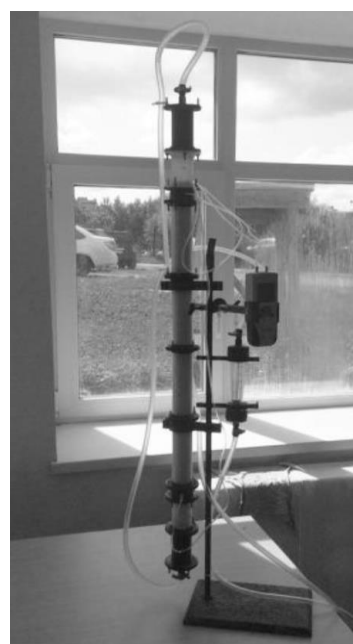
Рисунок 1 – Экспериментальная установка: а) схема установки; б) фотография колонны; 1 – колонна с сорбентом; 2 – фильтры; 3 – входная камера; 4 – выходная камера; 5 – регулирующий клапан; 6 – гибкие трубопроводы; PD – дифференциальный манометр; F – расходомер
