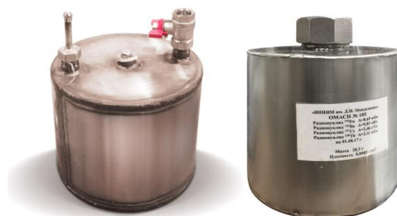
Рисунок 3 – Внешний вид сосуда Маринелли и объемной меры активности специального назначения
