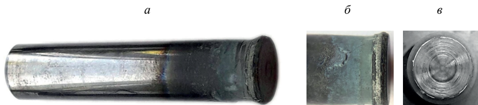
Рис. 3. Твердосплавный инструмент WC–Co (10%)–Cr (0,5%) после фрикционной закалки стали 20X13 (а), разбухание наконечника (б) и фрикционный характер износа плоского торца (в)
