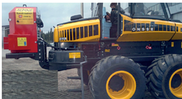
Рис. 2. Лесозаготовительная машина (харвестер) с лебедкой [1]
