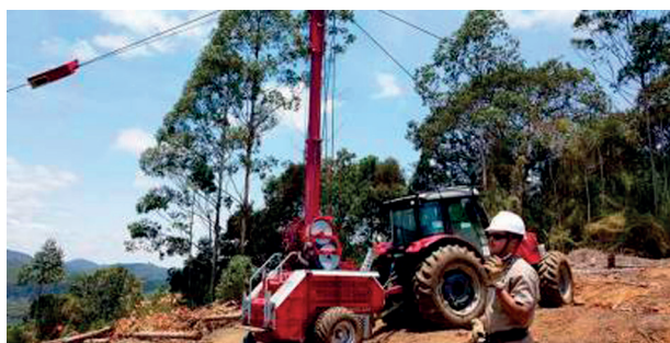
Рис. 1. Лесная канатная дорога на склоне
