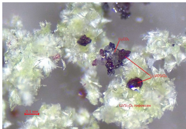
Рис. 1. Продукты кристаллизации гидротермальной системы \text{SiO}_2 - \text{Li}_2\text{CO}_3 - \text{VO}_2 , T = 450^\circ\text{C} , P = 250 атм. На фото представлены зелёные игольчатые сростки кристаллов \text{LiVSi}_2\text{O}_6 со структурным типом пироксена, красные таблитчатые кристаллы \text{Li}_2\text{VOSiO}_4 и бесцветные прозрачные кристаллы \text{Li}_2\text{CO}_3
