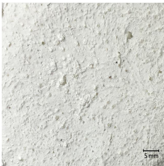
Рис.1. Поверхность пористого композита состава \text{Cd}_2\text{Zr}_2\text{O}_7 – керамическое волокно
