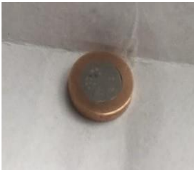
Рис. 1. поперечное сечение композита Cu/Al/Mg
