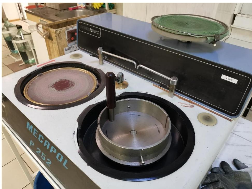
Рисунок 2.3 Шлифовально-полировальное устройство MEGAPOL P252.
