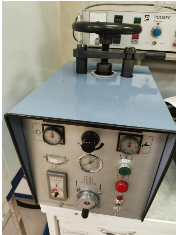
Рисунок 2.1 Прессовальный аппарат MECAPRES C
