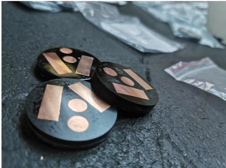
Рисунок 2.2 Образцы зашлифованные (шайбы).
