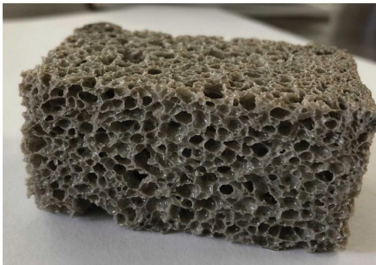
Рис. 3. Содержание шлаковаты — 15 %, микрокальцита — 0,7 %,  $T_{всп} = 880 \text{ }^{\circ}\text{C}$
