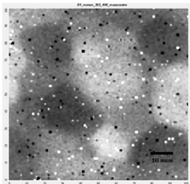
рис.1. Спектры комбинационного рассеяния керамики 3at%Yb:LuAG: (а) локальный спектр в диапазоне от  $300\text{см}^{-1}$  до  $500\text{см}^{-1}$ , (б) изображение, полученное после анализа пиков по значениям центра-масс интенсивности в спектрах комбинационного рассеяния поверхности 3at%Yb:LuAG размером  $85 \times 85\text{ мкм}$
