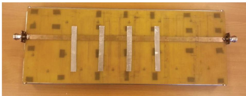
Рисунке Г.6 – Пример нанесения полосок на диэлектрическую подложку
