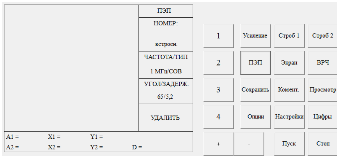
Рис. 1. Интерфейс ультразвукового дефектоскопа Интротест-1М
