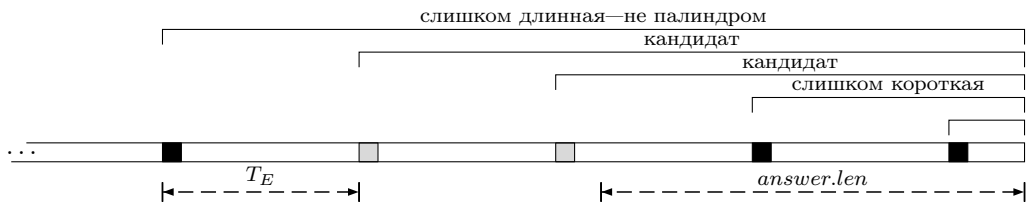
Рис. 1: Поиск палиндрома, который может обновить ответ. Квадраты обозначают позиции j , такие что фрейм префикса S[1..j - 1] сохранён; скобки показывают подстроки, которые могут быть проверены на палиндромность. Только подстроки-«кандидаты» могут быть палиндромами длины > \text{answer.len} .
