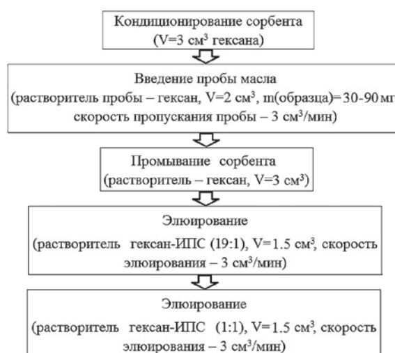
Рис. 2. Схема пробоподготовки методом ТФЭ.
