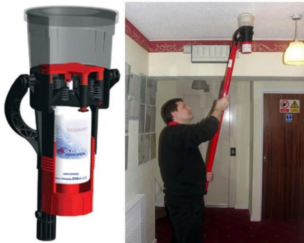
Рисунок 3 – Внешний вид тестера серии SOLO для проверки дымовых и газовых извещателей
