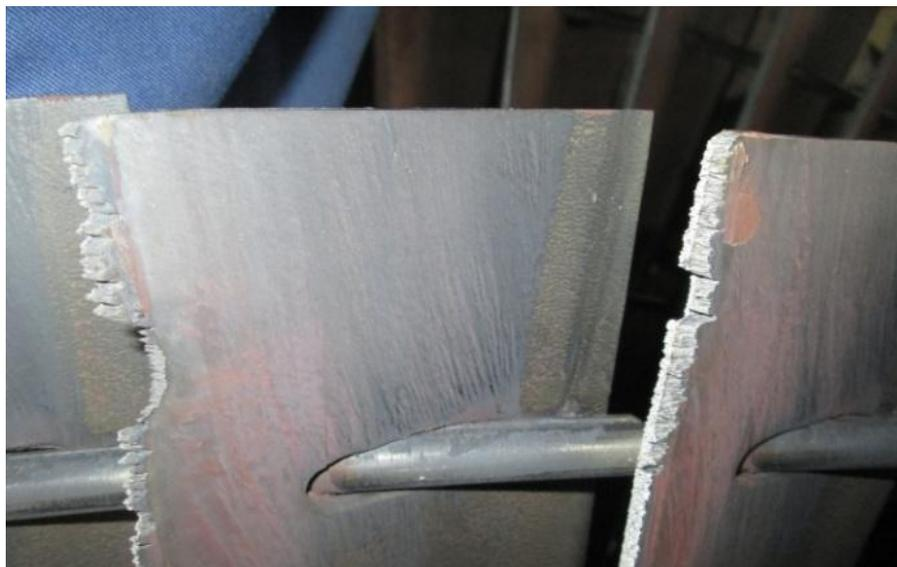
Рис. 2. Вырыв-скол металла на входной кромке металла ступени № 28 турбины Т-185/220-130-2 Кировской ТЭЦ-5
