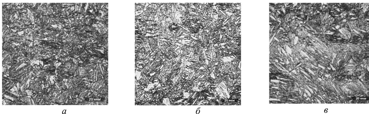
Рис. 1. Микроструктура образцов: *a* – A15, *б* – A150, *в* – A650
