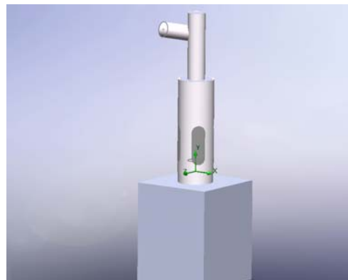
Рис. 2. Обработанная и исследуемая модель горелки, совмещенная с горелочным камнем
