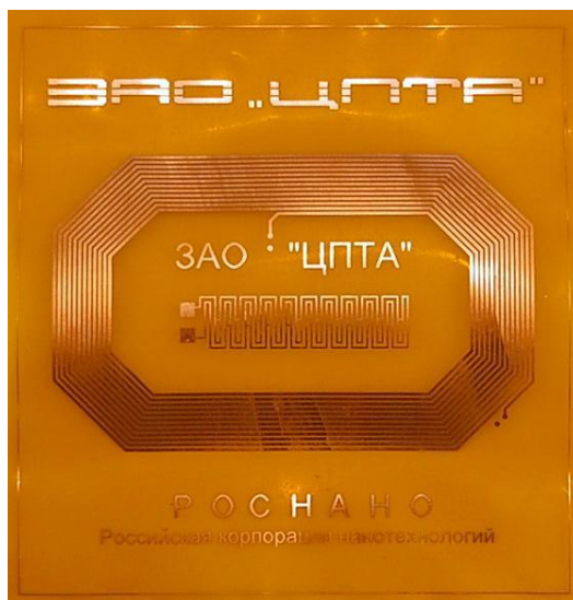
Рис. 11. Внешний вид печатной платы, полученной с использованием фольги из микрокомпозиционного сплава Cu-14%Fe.
